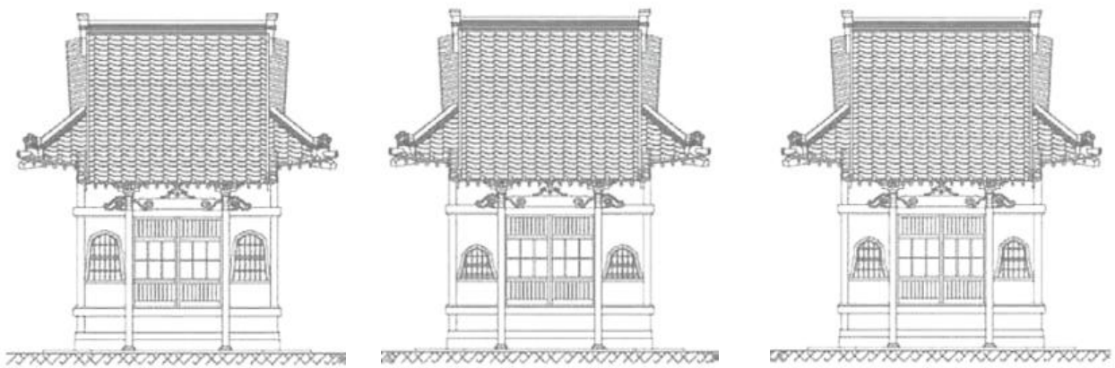
図22 立面図比較 (花頭窓の比較検討) 左から、A案・B案・C案 宮本正崇作図
